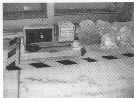
図6 中国 ゴム練り工場 原材料試験室 融点を測定しゴム薬品の純度を確認
